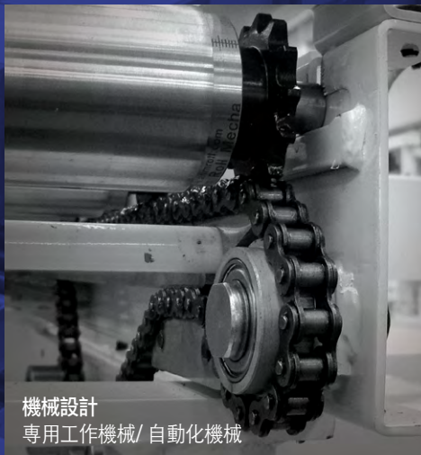
物流システム Conveyor Roller - Accumulation Roller 生産
